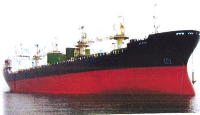
Το M/V Alpha, ένα φορτηγό πλοίο χύδην φορτίου με DWT 28000MT εξοπλισμένο με 4 γεραμούς 25 MT
