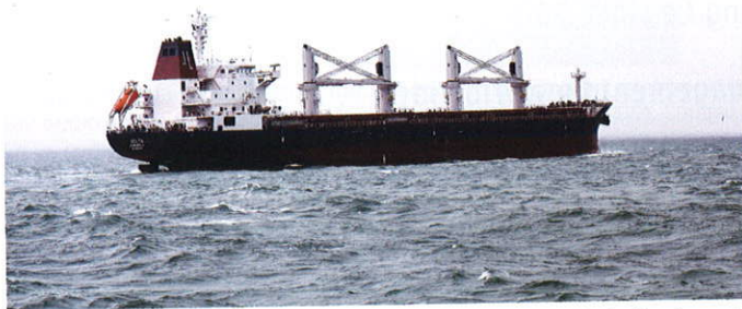
Το M/V DELTA, ένα φορτηγό πλοίο χύδην φορτίου με DWT 37,175 MT, εξοπλισμένο με 4 γερανούς 36 MT
